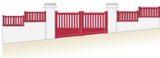
**Rue en pente avec des piliers de même hauteur :** le portail est réalisé avec des traverses hautes et des traverses basses en suivi de pente.
