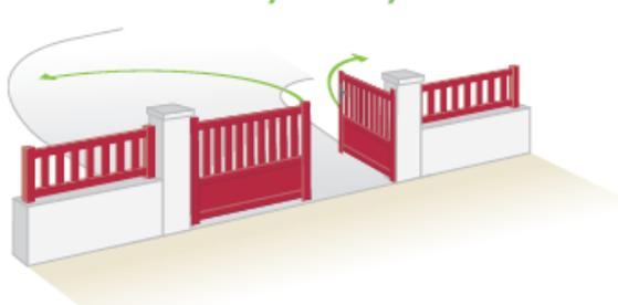
Dans certaines configurations, pour faciliter le passage des véhicules, le portail est conçu en deux vantaux de tailles différentes : 2/3 - 1/3.
