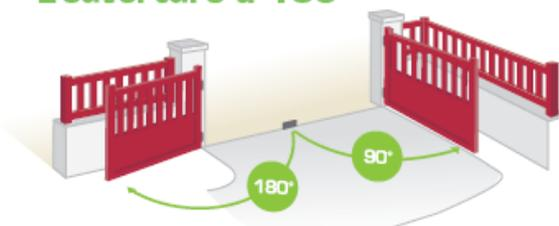
Tous les angles d'ouverture sont envisageables de 90° à 180°. Dans le cas d'une ouverture à 180° le dégagement latéral doit être au moins égal à la largeur du vantail et le portail est fixé au bord intérieur des piliers.
