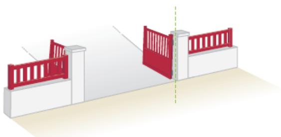
Si votre portail à battants s'ouvre sur un chemin montant, il doit être équipé de gonds régulateurs de pente.
