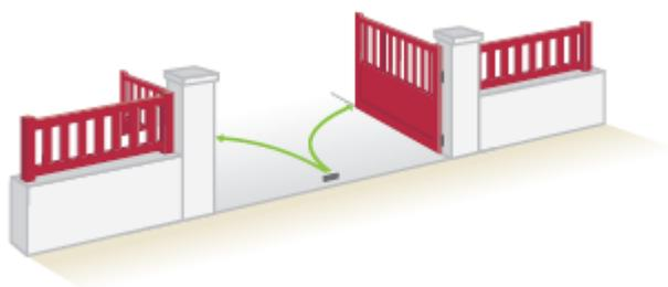
Le portail se compose de deux vantaux ouvrant vers l'intérieur ou vers l'extérieur. Les vantaux peuvent avoir des angles d'ouverture de 90° à 180°.
