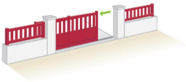
Le portail coulissant s'ouvre latéralement, à gauche ou à droite, en suivant un rail de guidage au sol. Adapté aux accès montants et aux cours exigües, il permet un effacement total du portail et facilite ainsi les manœuvres de votre voiture.
