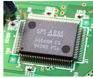
Microprocesseur de la carte électronique de la centrale d'alarme
